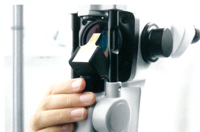
ミラーベース部だけを動かして、スリット光を容易に偏心
